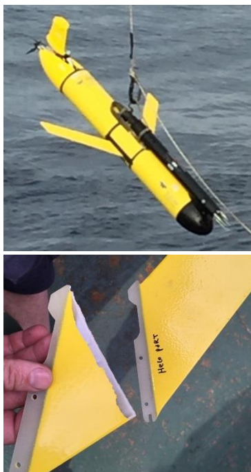
左：圖六 水下滑翔儀(Sea Glider)在南海作業照片，下圖為右翼折斷，與未斷的左翼比較。右：圖七 水下滑翔儀 7/16 上午的潛航紀錄，橫軸為時間，縱軸為深度，色階為傾角，藍色為下潛時傾角向下，紅色為上升時傾角向上。
