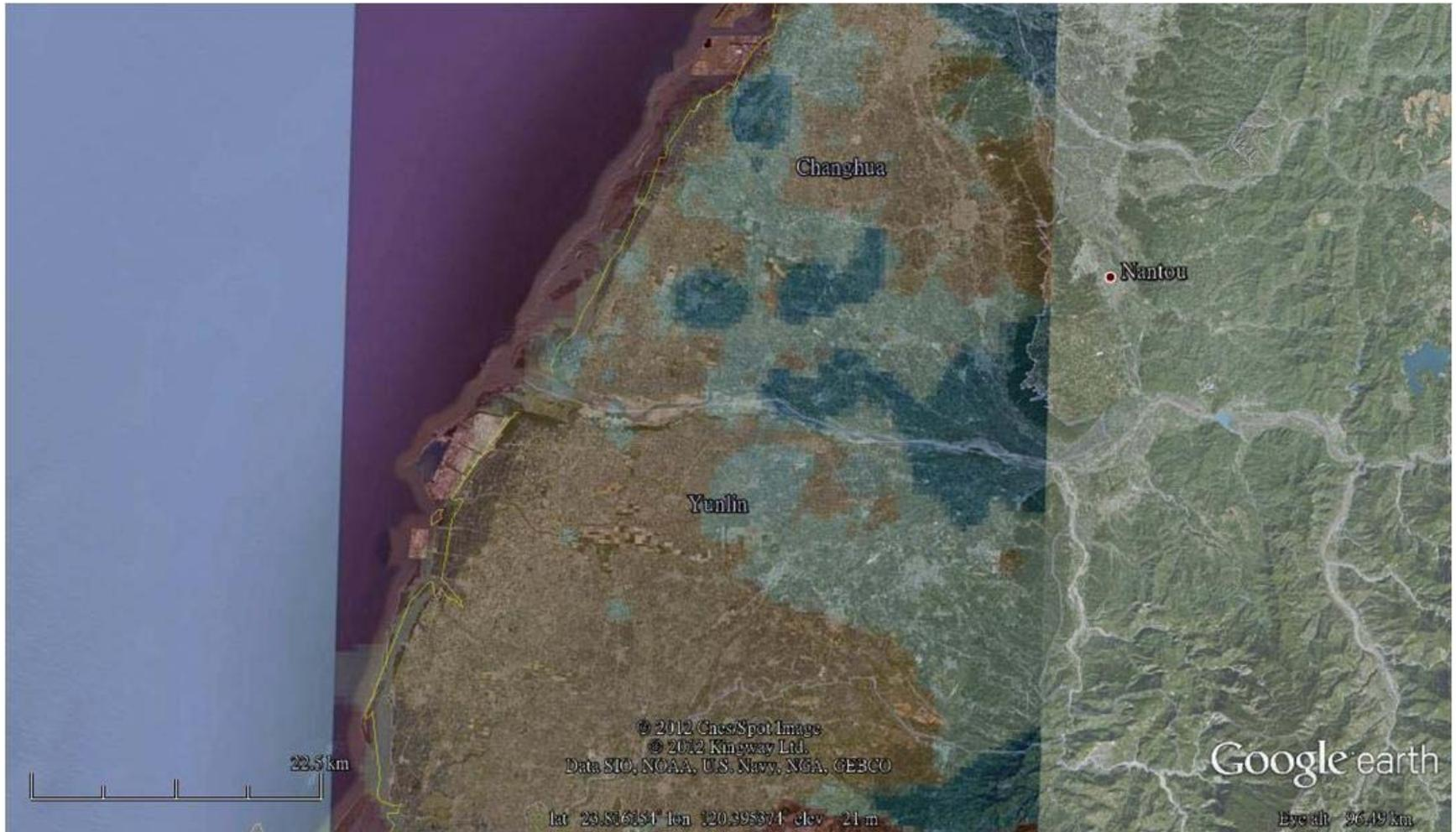
濁水溪扇洲之礫-砂-泥岩性表徵模型的近地表水平切面(藍色區塊顯示礫石層分佈，白色區塊顯示砂層之分佈，橙紅色則為泥質地層分布區域):現生沖積扇洲分佈(F1)
