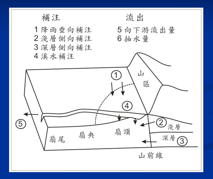
河川與地下水交換有多少? 入滲或是出滲? 河床阻塞的影響? 豐水季與枯水季的量? 不同河流的差異(河水含砂量)的影響? The Impact of Floods on Infiltration Rates in a Disconnected Stream
